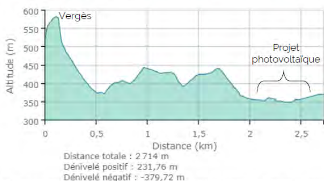
Figure 6 : Profil altimétrique entre le pic de Vergès et la zone de projet comprise entre 2,2 et 2,6 km - Geoportail
